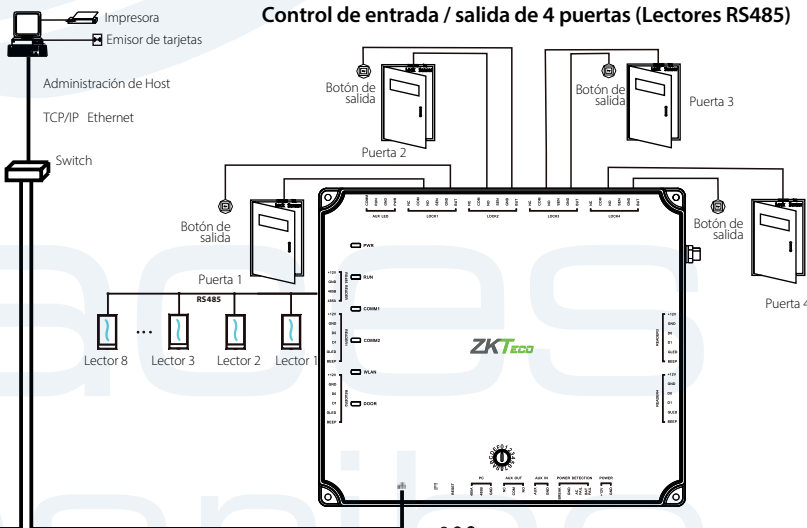
Control de entrada / salida de 4 puertas (Lectores RS485)
