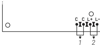
1. Salida de contacto seco tipo NA (Normalmente Abierto)
